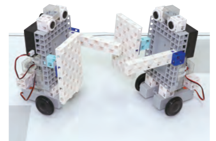
使うパーツ モーター×2、LED、プザー、タッチセンサー、赤外線フォトリフレクタ
